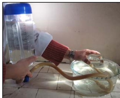
Figura 3: Desplazamiento del agua por burbujeo de \text{CO}_2
